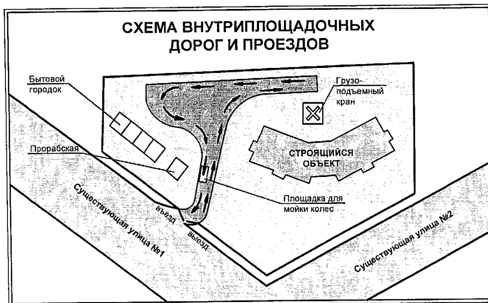
Рисунок Г.2 - Пример оформления информационного щита "Схема внутриплощадочных дорог и проездов"
