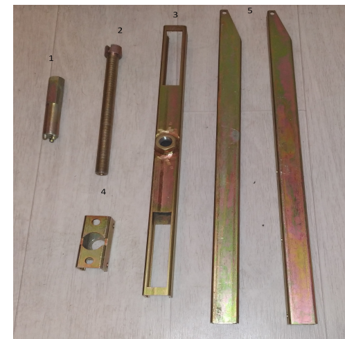
Рисунок 1.1 – Конструкция УЗЛ-2Р 1 – ключ; 2 – вал (Винт с секретом); 3 – направляющая; 4 – крепление; 5 – рычаги
